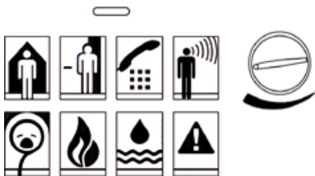
Figure 3 : Symboles, témoin de contrôle et bouton de réglage du volume
