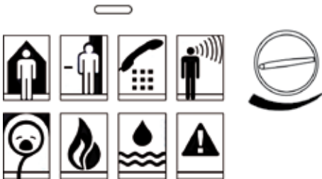
Abbildung 3: Symbole, Kontroll-Lampe und Lautstärkereger
