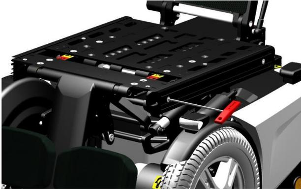
étape 8 : remplacez les rails latéraux en position et serrez les boulons.
