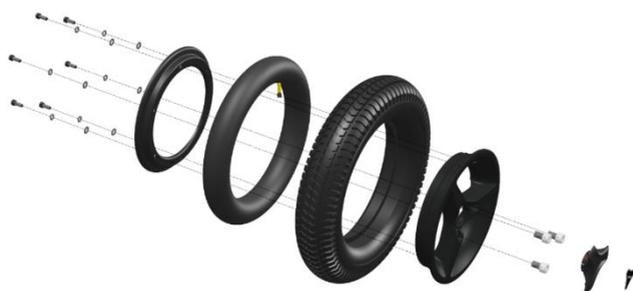
Après avoir retiré les roues du fauteuil, la jante peut être séparée. Le pneu peut ensuite être réparé. Les chambres à air des pneus peuvent être réparées conformément à la description du kit de réparation des crevaisons que vous utilisez. Il est cependant recommandé de changer la chambre à air dès lors qu'il y a une crevaison.
