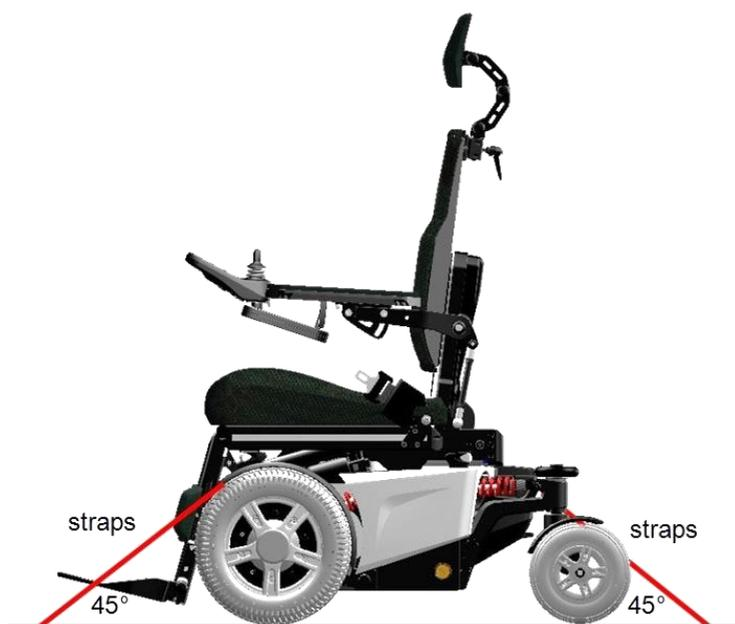
Ces sangles doivent être attachées au véhicule à des points d'ancrage conformes. Assurez-vous que la pression des pneumatiques est correcte pour une efficacité optimale des sangles. Assurez-vous que les sangles sont bien tendues pour une sécurité maximale.
