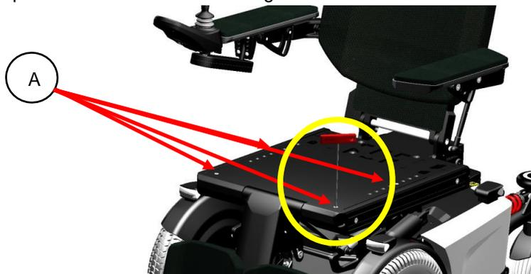
étape 2 : desserrez les vis du plateau d'assise (A) à l'aide d'une clé Allen de 3 mm.
