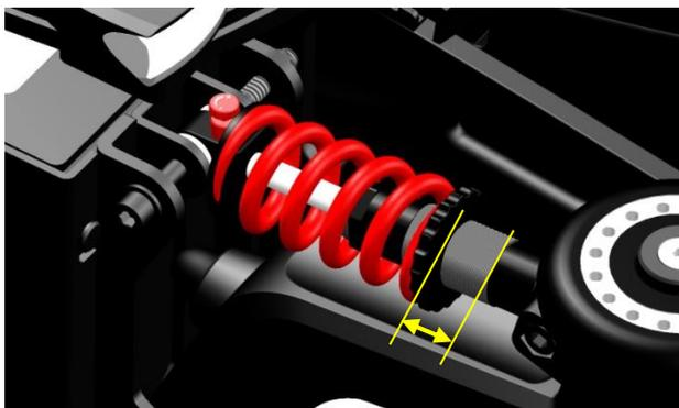
La mesure se prend à partir de la bride jusqu'à la fin du filetage en mm. Assurez-vous que les réglages des ressorts à l'avant sont identiques. Vérifiez que c'est également le cas pour les deux ressorts arrière.
