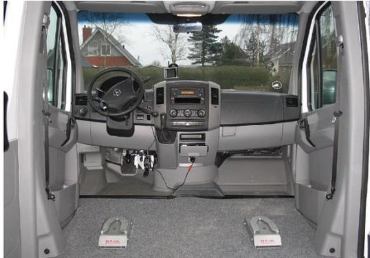
*Station d'arrimage Dahl montée sur le sol*
