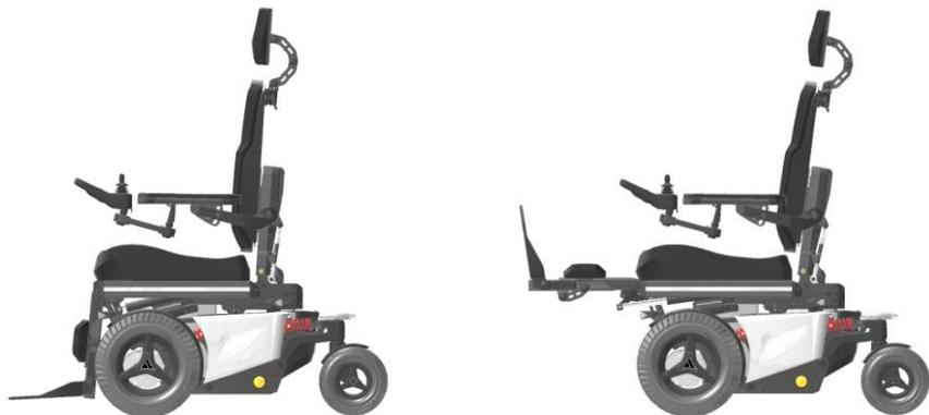
Au-delà d'une élévation du repose-jambes à 45°, la vitesse du fauteuil est automatiquement limitée pour des raisons de sécurité.
