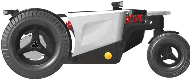
Chaque roue avant est propulsée par un puissant moteur. Ce moteur assure également la direction du fauteuil. Le système permet au fauteuil de tourner sur lui-même. Il est donc optimal pour une utilisation en intérieur.
