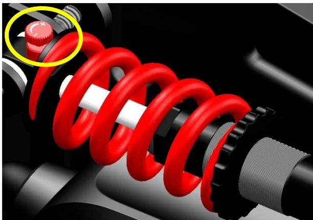
Tournez la molette rouge dans le sens horaire (vers la direction +) pour réduire l'amplitude de mouvement du piston. Cela affermit l'amortissement. Tourner la molette rouge dans le sens antihoraire assouplit l'amortissement. Des tests de conduites avec différents réglages doivent être effectués pour déterminer le bon.
