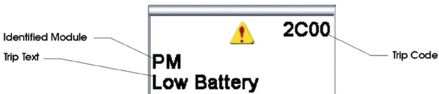
Cela indique une erreur système, c'est-à-dire que le dispositif R-net a détecté un problème dans le système électronique du fauteuil.
