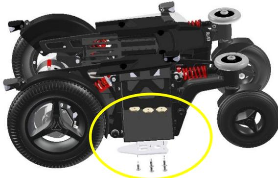
*Montage de la plaque d'arrimage Dahl sur le châssis du fauteuil EvO*
