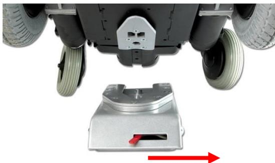
Pour déverrouiller la station d'arrimage manuellement, vous devez tirer le levier rouge vers la droite. Cette action permet de rétracter le verrou manuellement pour que le fauteuil roulant soit détaché de la station d'arrimage.
