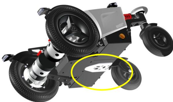
*Châssis EvO munit d'une plaque d'arrimage Dahl.*
