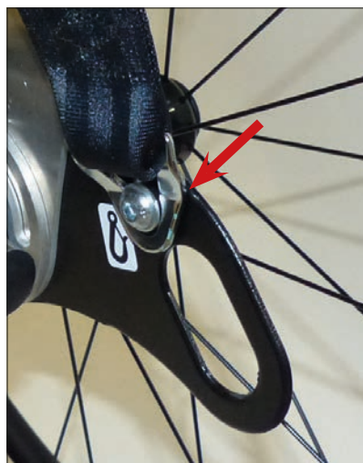
Befestigungspunkt, hinten nach ISO 7176-19 für Beckengurt
