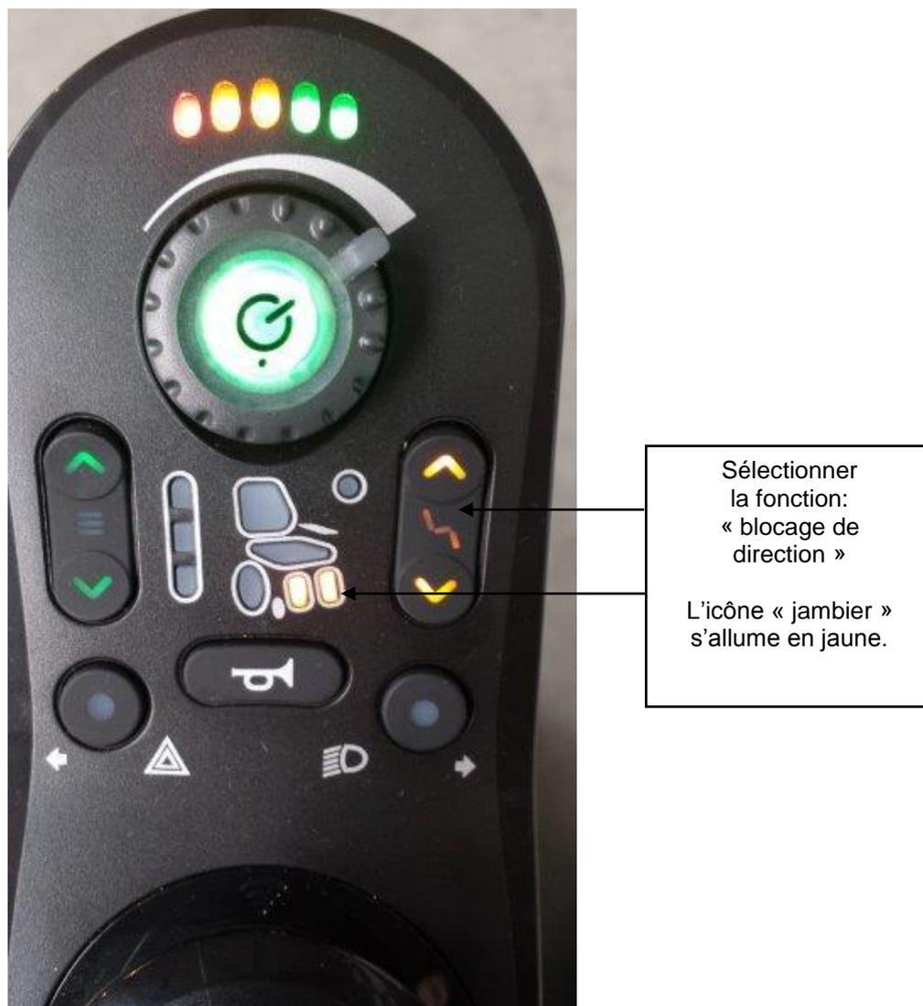
Le blocage de direction est très utile lors de déplacement sur des surfaces boueuses, enneigées, ensablée, rocailleuse ou bien encore pour maintenir le véhicule droit le temps de monter des rampes d'accès.
